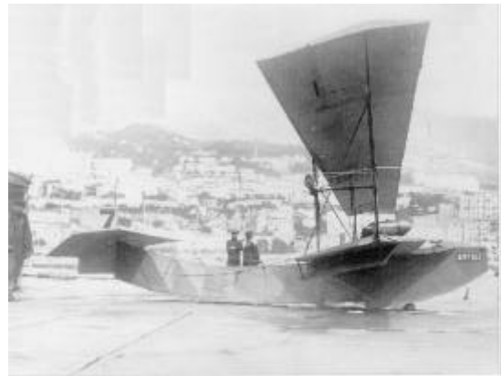
Le d'Artois coulera le 13 avril 1913, tuant son pilote. Son moteur est dans la coque et l'hélice est entraînée par chaîne.
