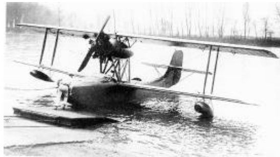
Le FBA-23 à moteur en étoile Gnôme & Rhône « Jupiter » 9Ab de 420 ch destiné à Maurice Noguès photographié en 1926 à Argenteuil. (Cliché Musée de l'Air).
